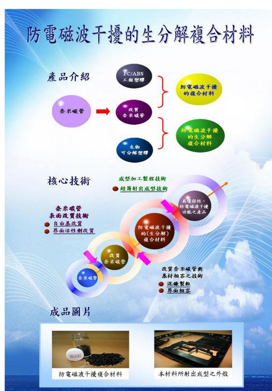
「防電磁波干擾的生分解複合材料」，是將石油提煉的PC/ABS工程塑膠原料，轉換成由植物纖維所提煉的生物可分解塑膠，再與改質後的奈米碳管結合而成。
